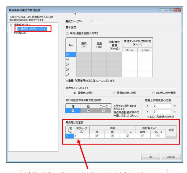
主架構の床グループ ID のみが選ばれていることを確認します。 履歴ダンパーを使用している場合などは必要に応じてばねの追加及び質点ばねとして集計する部材のチェックの変更をしてください。
